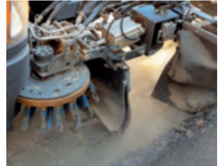
Die Alternative – Spezialfahrzeug für alles aus einer Hand: Fräsen, Absaugen, Verfugen und Waschen
