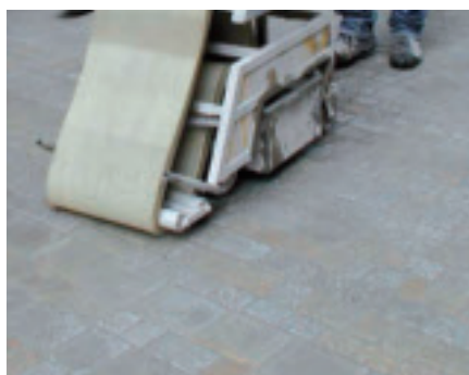
8. Reinigung größerer Flächen mit Schwammfix-Maschine
